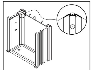
5. Décollez l'endos du ruban double-face du dos du panneau. Positionnez le panneau à environ 30 degrés, poussez le rebord coupé dans le coin, puis poussez le panneau avec soin vers le mur arrière.
