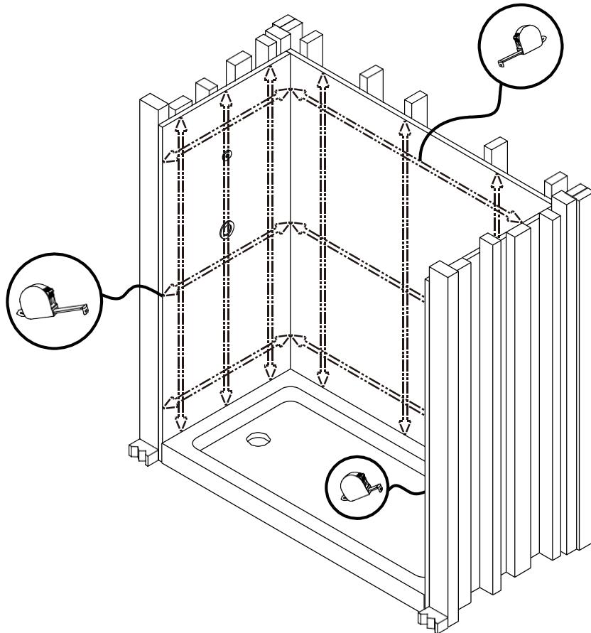
3. Mesurez les emplacements de découpe pour les éléments de plomberie et marquez-les au dos du/des panneau(x) approprié(s).
