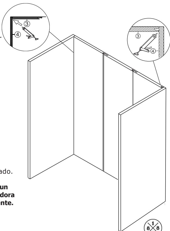
**Nota importante:** Mantén toda el área seca durante un mínimo de 24 horas para permitir que la pasta selladora y el adhesivo de construcción fragüen apropiadamente.
