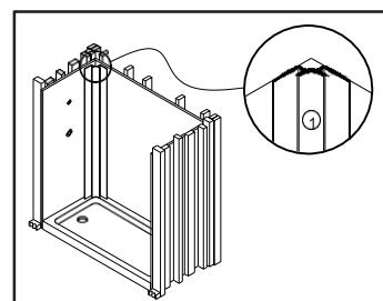
5. Despega la parte posterior de la cinta de doble cara de la parte posterior del panel. Coloca el panel aproximadamente a 30 grados, presiona el borde cortado hacia la esquina y luego empuja con cuidado el panel hacia la pared trasera.
