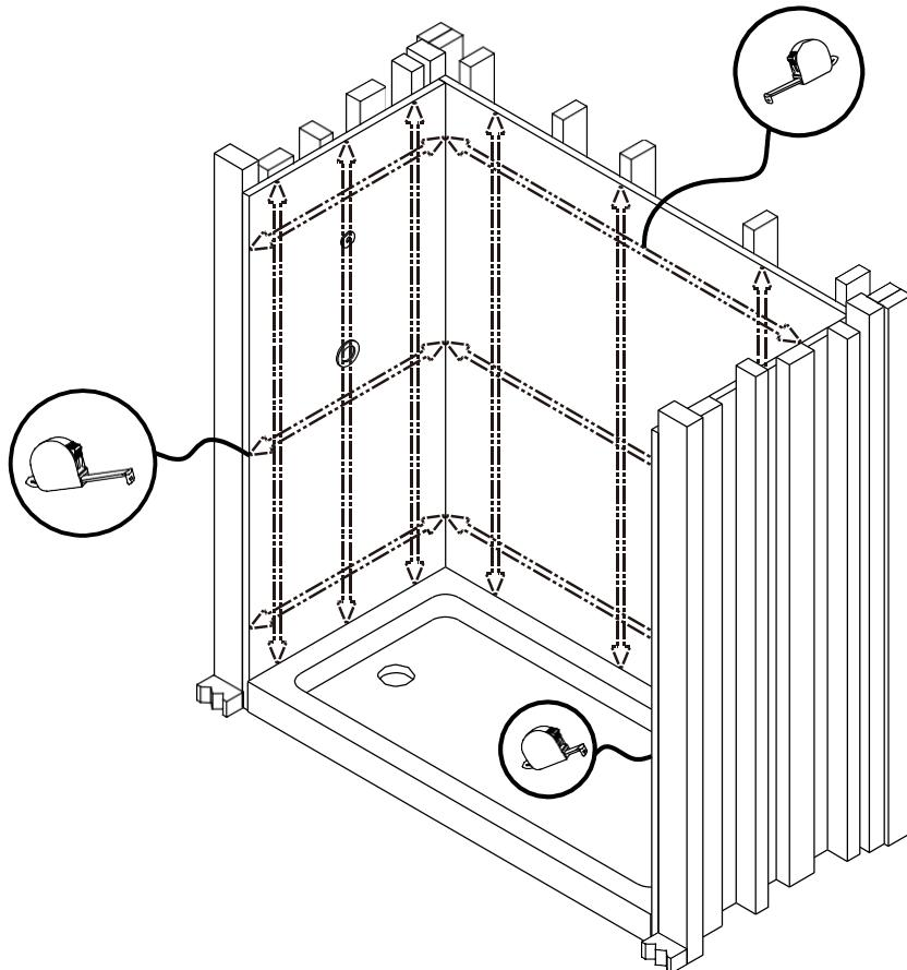
3. Mide las ubicaciones de los recortes para los accesorios de plomería y márcalos en la parte posterior de los paneles apropiados.
